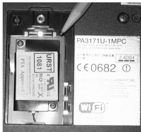
Figure 7-1 A mini PCI wireless NIC
